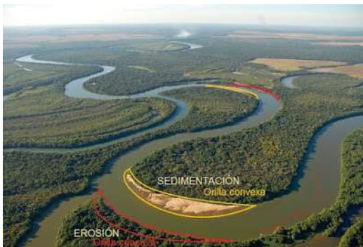
Geometría del cauce de un río y velocidad relativa del agua
